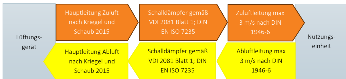
Abbildung 5: Vereinfachtes Schema für die Auslegung von Luftleitungen
