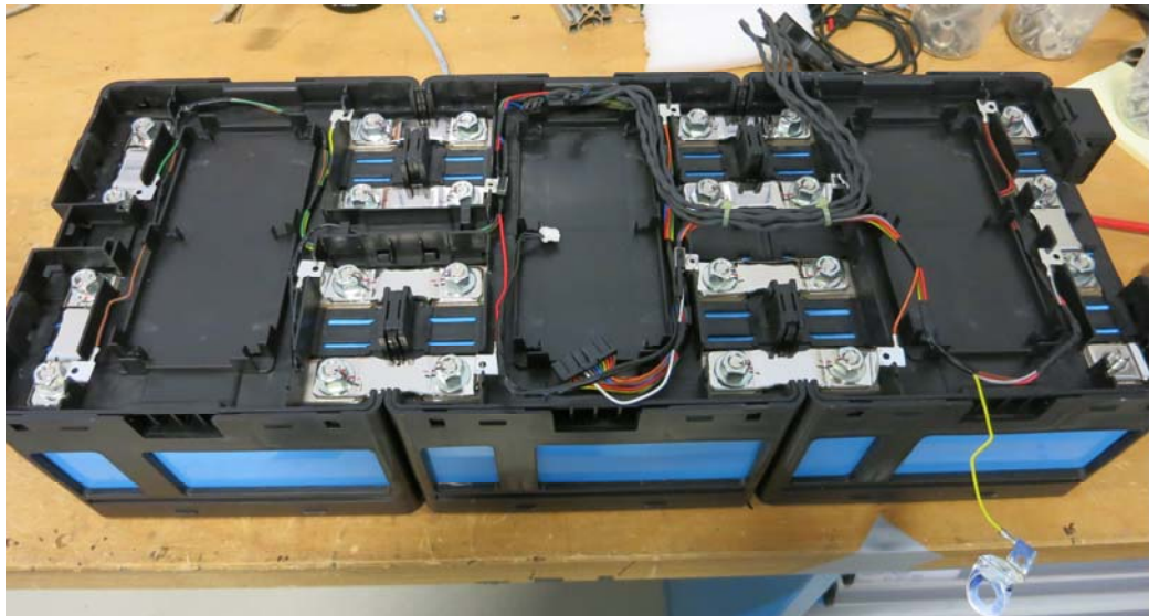
Abbildung 8: Blick in das geöffnete Modul des GS YUASA Batteriespeichers, Quelle: Fraunhofer ISE
