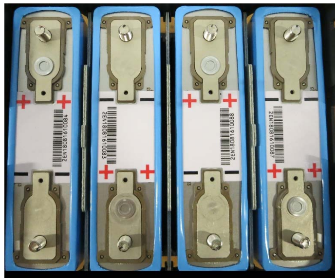
Abbildung 9: Vier Zellen des GS YUASA Batteriemoduls mit Trennplatten zwischen den Zellen, Quelle: Fraunhofer ISE
